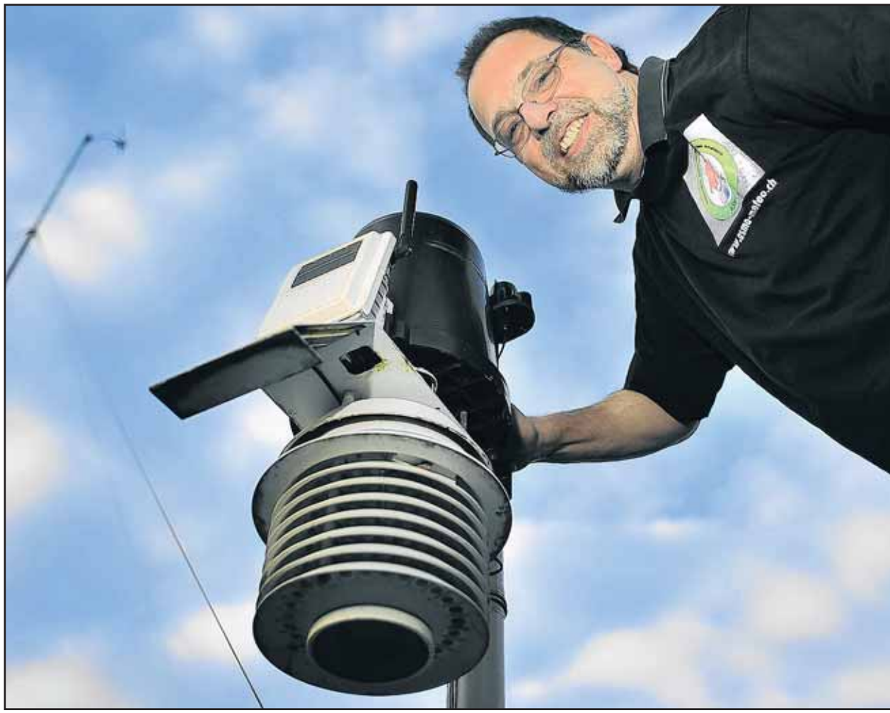
Président de l'ASMA, Philippe Henry bichonne sa station météo semi-professionnelle, à l'impasse Creux-du-Van, à Payerne. A gauche, on aperçoit sa girouette qui culmine à 10 m du sol, selon les normes mondiales. ALAIN WICHT
